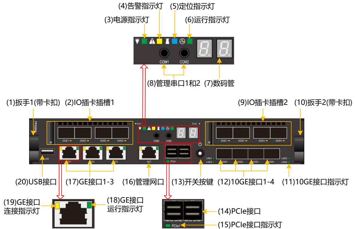
图3-12 FSU5500B/FSU5500 的 FP 正视图
