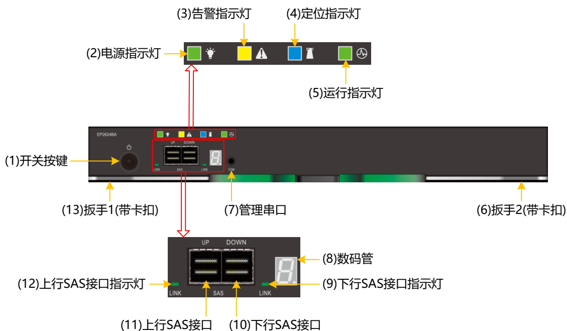
图3-27 DSU2624B 的 EP 正视图
